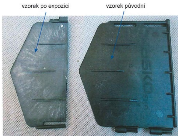
Obr. 1 Plastový obrubník z materiálu PA66 drť Technyl, evid.č. 462200138-2058/01 – po expozici v souladu s normou ČSN EN ISO 4892-2 – tabulka 3, metoda A, cyklus 1.
